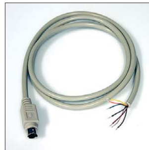
K-MDIN-ST6M: Kabel mit Mini-DIN-Stecker, 6-polig, männlich, Länge ca. 0,8 m, Rundkabel, alle Adern gemeinsam abgeschirmt, Schirm am Steckergehäuse
