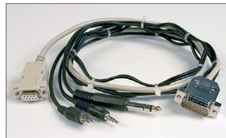
Bild 20: Ein aus einseitig konfektionierten Leitungen (Sub-D9, Cinch, Klinkenstecker), Sub-D15-Steckverbinder und Griffschalen aufgebautes Anschlusskabel für den Yaesu FT-847
