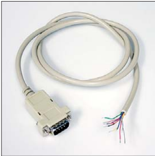
K-SUBD-ST9M: Kabel mit SUB-D-Stecker, 9-polig, männlich, Länge ca. 0,8 m, Rundkabel, alle Adern gemeinsam abgeschirmt, Schirm am Steckergehäuse
