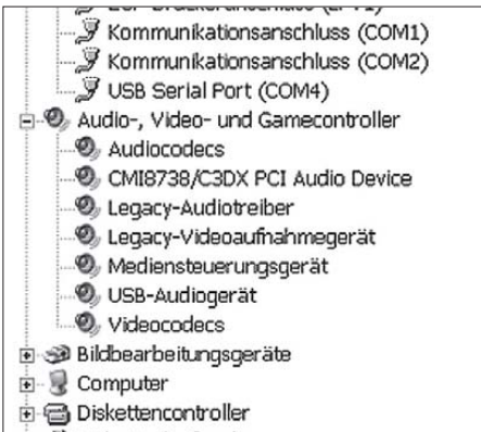
Bild 18: Hat alles geklappt, erscheinen die Geräte USB Serial Port und USB Audiogerät unter Windows im Geräte manager.
