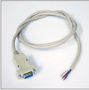
K-SUBD-ST9W: Kabel mit SUB-D-Stecker, 9-polig, weiblich Länge ca. 0,8 m, Rundkabel, alle Adern gemeinsam abgeschirmt, Schirm am Steckergehäuse
