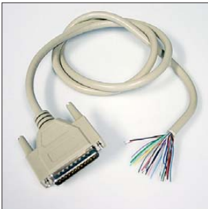
K-SUBD-ST25M: Kabel mit SUB-D-Stecker, 25-polig, männlich Länge ca. 0,8 m, Rundkabel, alle Adern gemeinsam abgeschirmt, Schirm am Steckergehäuse
