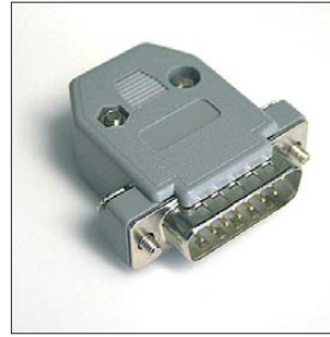
SUBD-15M: SUB-D-Stecker, 15-polig, männlich, Lötkelch + Kappe; ein Exemplar ist im Lieferumfang des Bausatzes BX-120.
